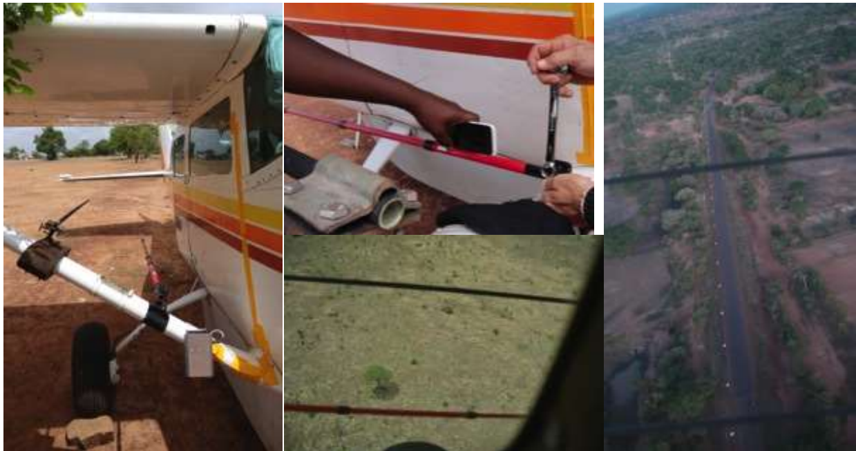
Fig 6. Fixation, ajustement des tiges (gauche et milieu) et calibrage (droite). Inventaire aérien du WAP 2015.
