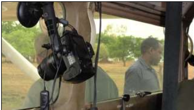
Fig 8. Appareil photo orienté vers la bande de comptage Inventaire aérien du WAP 2015.
